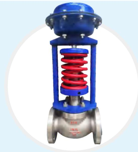
自力式控制阀无需外加能源，利用被调介质自身能量为动力源。自动控制阀门介质流量，使阀后压力保持恒定的压力稳定装置。有ZZY直接作用型自力式压力调节阀、ZZYV型带指挥器操作型自力式压力调节阀、ZZV型自力式微压调节阀、ZZD氮封装置等类型。广泛应用于连续送气的天然气采输，城市煤气以及冶金、石油、化工等工业生产部门。
