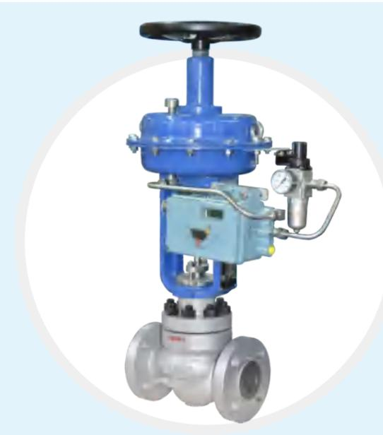
LN81/82 系列顶导向单座控制阀，采用流体压力不平衡型柱塞阀芯，阀盖顶部导向，浮动压紧式自对中阀座结构。调节精度高，结构简单可靠，密封性能好，方便安装和拆卸，维护成本低，适用于压差不高，泄漏量低，控制精度高的场合。
