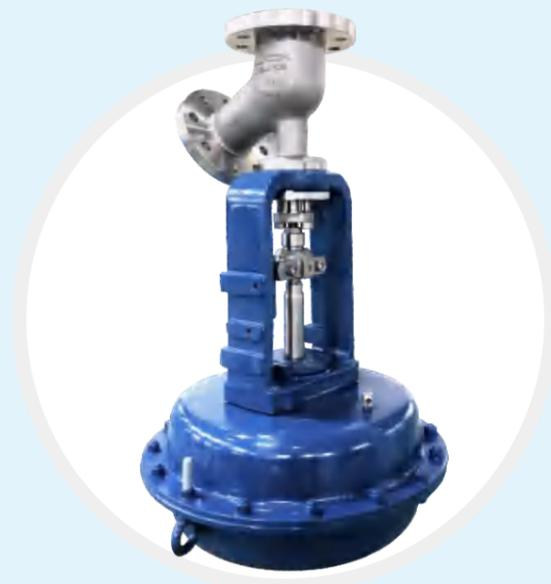
GL系列上展式/下展式放料阀是一种特殊的单座调节阀，该阀阀体采用一体式直流Y型结构，阀内腔无阻挡流道，内表面经喷砂处理，阀门无死角。可选配AM8气动薄膜执行机构、AH8气缸执行机构。广泛用于精细化工、制药等行业控制控制容易沉积或含有颗粒的流体。适用于反应釜底对安装空间苛刻的场合。
