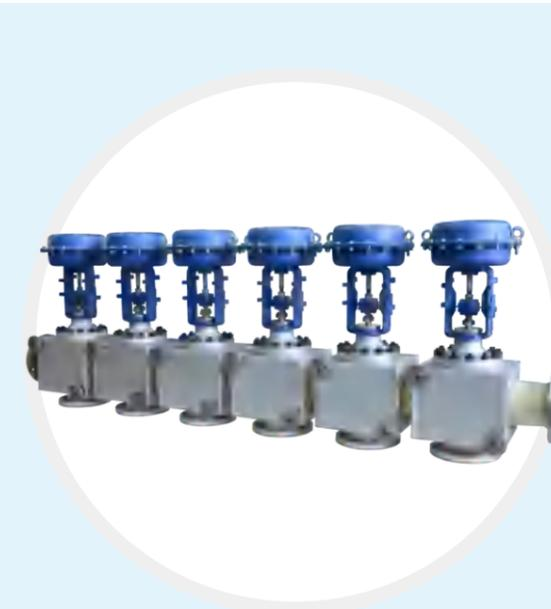
LN8系列气动放料阀组阀体外采用保温夹套形式，对放料阀组中的每一台阀分别焊接保温夹套，有利于分体测试各个阀门的性能，从而保证各阀焊接在一起时的整体性能。六台阀焊接在主管道上。其中，每台阀进口或出口共有三个，相邻的两台阀焊接在一起，6台阀阀体内部相通，由阀座来控制分管道的启闭。
