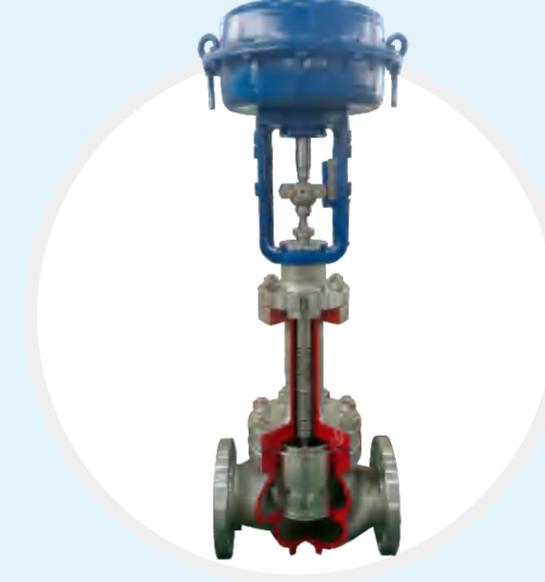
LN83W/85W/87W 系列波纹管套筒导向控制阀，基于LN83/85/87系列控制阀结构上增加波纹管密封结构，耐压的弹性不锈钢波纹管置于支座部件内与阀杆连接在一起，与填料组成双重密封，消除介质外漏隐患。适用于剧毒、易燃、易爆、易挥发和稀有贵金属介质的调节。
