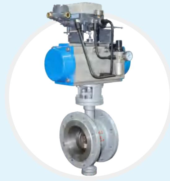
BN2302系列三偏心蝶阀，阀板采用三维偏心结构，启闭时，阀座与蝶板几乎无摩擦。蝶板密封圈为多层次不锈钢板与石墨复合板密封圈，密封性能优异。该阀口径大、操作扭矩小、流阻小、密封可靠，适用于大口径、低流阻、泄漏量小的工况。
