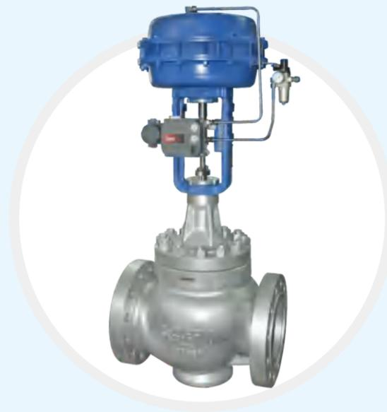
LN87系列套筒导向控制阀，采用流体压力平衡式阀塞，套筒内壁导向，浮动压紧式自对中阀座结构。动态稳定性好，操作力小，抗冲刷，允许压差大，方便安装和拆卸，维护成本低，适用于高压差，高噪音，高冲刷的各种高低温介质的苛刻工况。
