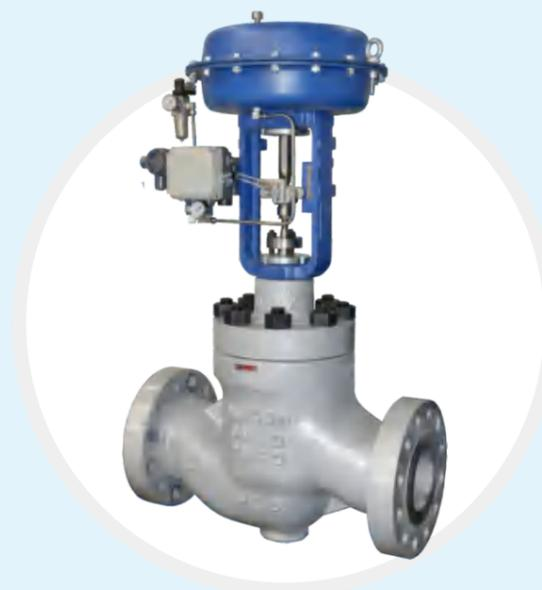
LM85/87 系列套筒导向高压控制阀是一种套筒导向压力平衡式高压单座控制阀。采用分离式套筒结构，高性能金属密封环密封。具有在高温高压下动态稳定性好，控制精度高，允许压差大，操作力小，流通能力大等特点，适用于苛刻工况下的流体控制。
