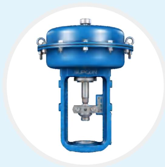
AM8系列气动多弹簧薄膜执行机构采用滚动式膜片，无褶皱、不拉伸、无翻转。内部零件模块化结构，可组合成多种规格。可配侧撞手轮或顶装手轮。线性好、精度高、反应灵敏、使用寿命长；最高供气压力可达0.5MPa，输出推力大，能适应各种不同的工况需求。
