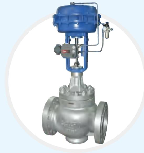
LN8800 平衡式单座控制阀，采用压力平衡式抛物线阀芯结构。与单座不平衡式控制阀相比，在执行机构推力较小的情况下，更能承受较高的工作压差。与普通套筒导向控制阀相比，调节精度更高，不容易卡死。O型圈、平衡密封环及活塞环的采用使阀门适用于不同温度的介质工况，而密封性能与单座阀相同，且动态稳定性更好。配用多弹簧气动薄膜执行机构或电动执行机构。安装快速方便、性能可靠。
