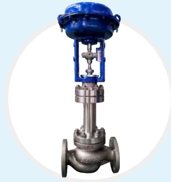
LN81W/82W系列波纹管单座控制阀，基于LN81/82系列控制阀结构上增加波纹管密封结构，耐压的弹性不锈钢波纹管置于支座部件内与阀杆连接在一起，与填料组成双重密封，消除介质外漏隐患。适用于剧毒、易燃、易爆、易挥发和稀有贵金属介质的调节。
