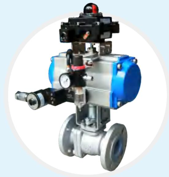
SN2401F系列衬塑球阀是一种转角位90°的旋转阀，具有极好的耐腐蚀性，凡与介质接触的部位，均用氟塑料隔离，主要选用氟塑料为PTFE、FEP，具有优良的密封性能，通常适用于密封性要求严格的场合。特别适用于强腐蚀性介质。球阀流通能力大，结构简单，维修方便，可配气动或电动执行机构。
