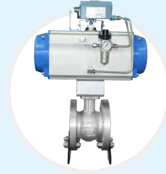
CN8系列偏心旋转控制阀在结构上，阀体、上阀盖为一体式结构，阀体内腔为流线直通型，流路简单，对流体运动阻力小，压降损失小，可减少阀体及阀内组件的冲刷。阀芯的回转中心不与旋转轴同心，可减少阀座磨损，延长使用寿命，阀芯上到有导流板，有利于流体动态平衡，具有优良的稳定性。其次，还有流量大、可调范围广等优点。特别适用于含淤浆的工艺系统控制。
