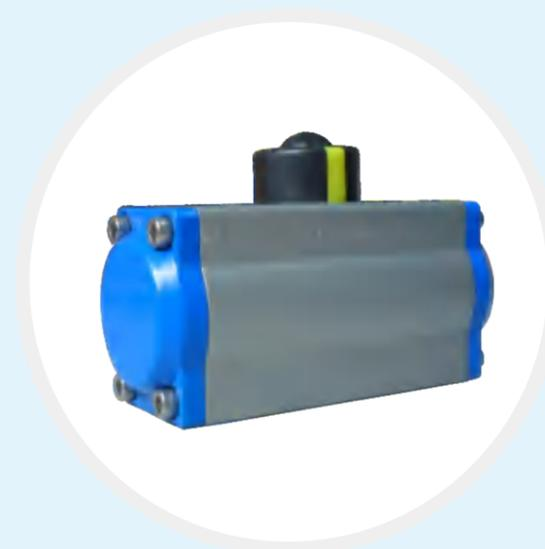
RH系列气动齿轮齿条执行机构有以下特点：①缸体采用优质合金铝挤压成形，表面硬质阳极氧化处理，环氧聚酯喷涂；②活塞采用铸铝硬质氧化处理，安装位置对称，动作迅速；③弹簧采用组合式，方便拆卸或改变弹簧数量满足不同的力矩输出；④活塞环采用低摩擦、长寿命符合材料，维修更换方便；⑤气源接口符合NAMUR标准，可直接安装NAMUR标准的电磁阀。
