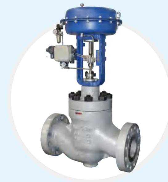
LM8580碟片式套筒导向高压控制阀（平衡环密封）是一种套筒导向，压力平衡式高压单座控制阀。采用新型迷宫碟片式套筒结构，高性能平衡密封环密封。多级降压、降噪，允许压差大、抗气蚀、降噪能力强等特点。适宜压差大、噪音强、气蚀严重等恶劣工况下的流体控制。
