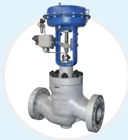
LM81/82系列多孔式高压单座控制阀是一种顶部导向、柱塞型高压单座控制阀。采用新型直压式浮动阀座结构。具有控制精度高，密封性能好，结构简单，通用性强等特点。多孔式压套的采用，极大地提高了内件的抗气蚀、降噪音性能。适用于较为苛刻工况条件下的流体控制。
