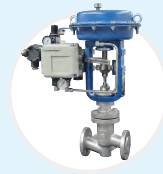
LN系列衬塑单座控制阀由气动薄膜执行机构（或电动执行机构）和直通单座衬塑阀两部分组成。该阀接触介质部位均使用具有耐腐蚀、耐老化的聚全氟乙丙烯（FEP），通过高压衬氟塑工艺制成。适用于常温、常压强腐蚀性介质工况。
