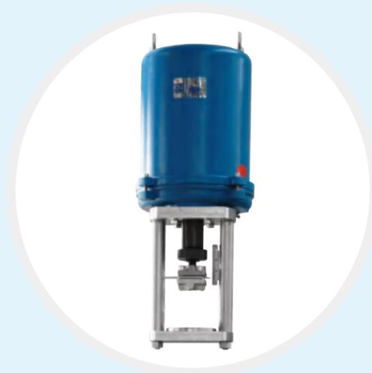
电动执行机构有220V交流单相电源和380V三相交流电源两种驱动电源的机型，接受来自调节器控制信号（DC 4~20mA或DC 1~5V），实现预定往复运动的新型执行机构。本系列执行机构几乎具备了调节阀本身所要求的各种动作变换功能以及阀开度信号功能和保护功能。因此被广泛应用于电力、冶金、石化、轻工及环保等工业部门。
