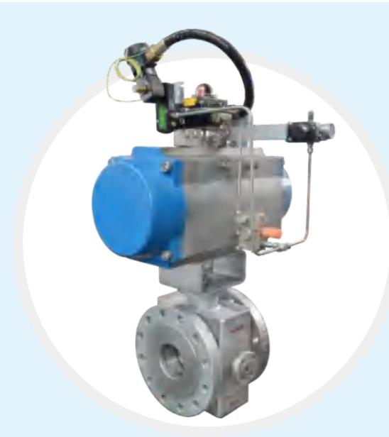
高温硬密封保温夹套球阀主要应用于反应釜连锁放料的控制。该阀为一体式带保温夹套固定式硬密封球阀。阀内件采用弹簧进行预压，使整个密封面受力均匀，并实现密封力的可调整。密封件采用平衡密封环，该密封环为单向结构，两侧装，流体流过时可产生双重密封但不是双向密封，采用平衡密封环做密封件，平衡密封环在此处的应用是一个全新的思路，能够在不同的压力下实现密封。
