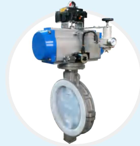
BN1101F系列衬塑蝶阀兼具硬衬的耐温性能与软衬的密封特性。阀门工作时，仅全氟塑阀座和衬氟型蝶板与介质接触，可承受除“熔融碱金属”和“元素氟”外的任何介质腐蚀、阀体通道内表面光滑，流体阻力小，流通能力强，扭矩适中。采用四级密封结构，并在密封面外配以耐温抗老化的SI橡胶的弹性衬塑阀座，完全达到介质零泄漏。
