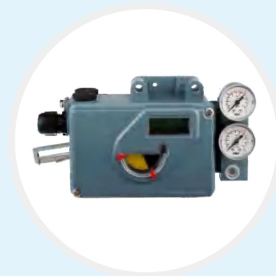
智能式阀门定位器采用微处理器控制，接收控制系统的模拟或数字信号控制气动控制阀，实现快速精确定位。可通过系统、计算机或手持终端设备进行组态调试，也可通过面板的按钮现场组态。LCD显示屏以及LED能显示提供阀门运行状态，为预测性维护使用阀门提供了有效手段。
