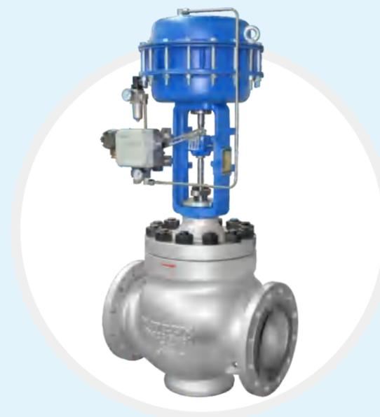
LN8600 套筒导向先导式控制阀，有一大一小两个阀芯，大阀芯的上下运动实现控制阀的开启或关闭，小阀芯的上下运动引导大阀芯的运动。此控制阀能实现较高的密封要求。适用于高压差、严密封的场合。
