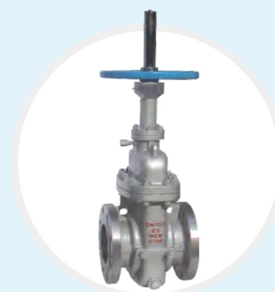
平板闸阀是一种关闭件为平行闸板的滑动阀。其关闭件可以是单闸板或是其间带有撑开机构的双闸板。闸板向阀座的压紧力是由作用与浮动闸板或浮动阀座的介质压力来控制。平板闸阀流阻小，能适用于带悬浮颗粒的介质、而且密封面可以实现自动定位。
