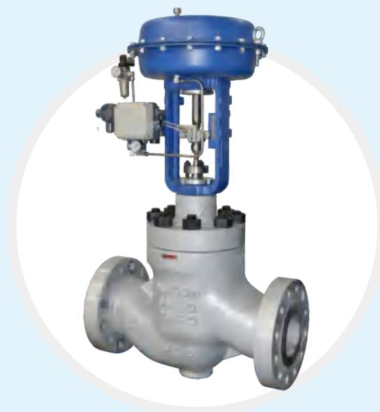
LM8560多级降压高压控制阀是一种套筒、阀座双向，压力平衡式高压单座控制阀。采用双层多孔式套筒和多孔式阀座结构，高性能金属密封环密封。四级降压、降噪，允许压差大、抗气蚀、降噪能力强等特点。适宜高温下压差大、噪音强、气蚀严重等恶劣工况下的流体控制。
