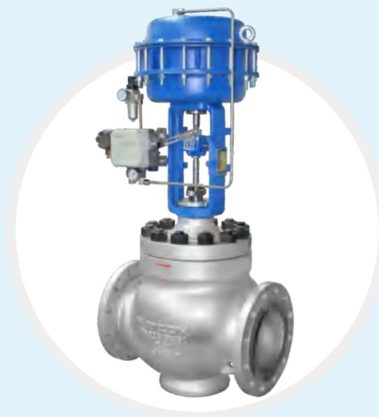
LN83/85系列套筒导向控制阀，采用流体压力平衡式阀塞，套筒内壁导向，浮动压紧式自对中阀座结构。动态稳定性好，操作力小，抗冲刷，允许压差大，方便安装和拆卸，维护成本低，适用于高压差，高噪音，高冲刷的各种高低温介质的苛刻工况。
