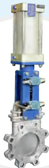
本系列刀闸阀是闸阀的一种，是直行程切断阀，刀闸阀的闸板头部有斜刃口，对介质具有一定的切断作用，适合用于含纤维及固体颗粒介质及污水处理系统中，可配手动，气动，电动执行器，广泛用于造纸、采矿、化工、污水处理等过程自控系统中。
